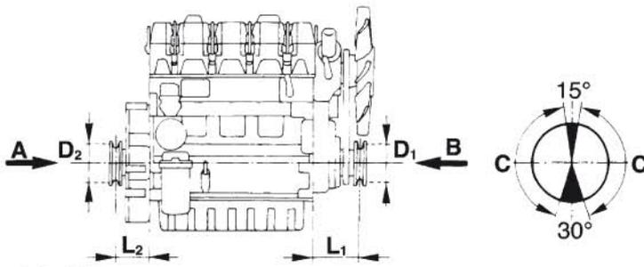
Courroie trapézoïdale  $D_2$  (mm)  $\geq 73 [L_2$  (mm) + 118]  $\frac{N$  (kW)
